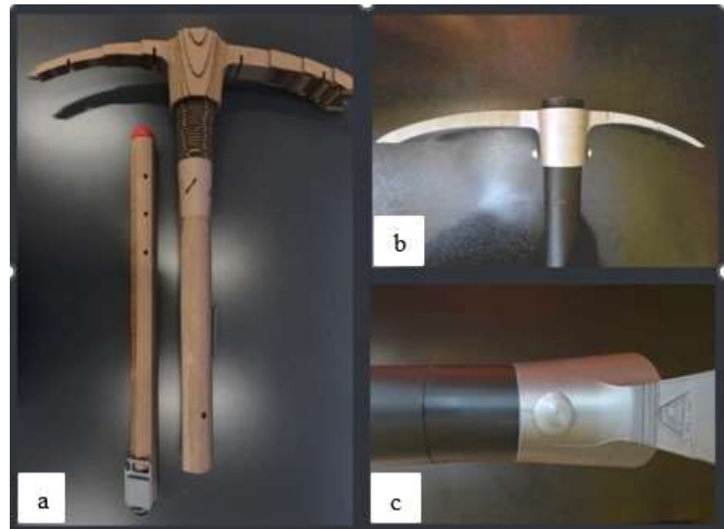
Fig. 2 a) Maqueta cardboard, b) Maqueta 3D: cabezal; c) Maqueta 3D: mecanismo de anclaje.
